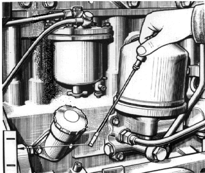
Рисунок 10 - Проверка уровня масла в картере дизеля.
