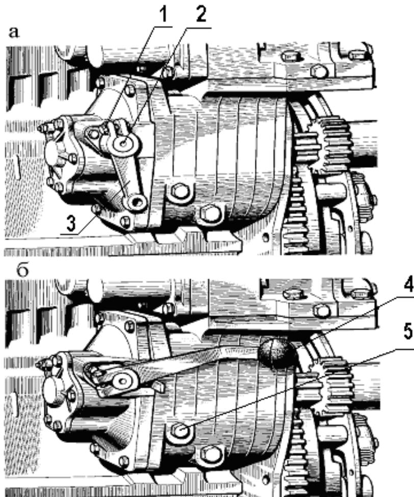
1 - стяжной болт; 2 - валик шлицевой; 3 - рычаг муфты включения; 4 - рукоятка муфты включения; 5 - пробка контрольного отверстия.
