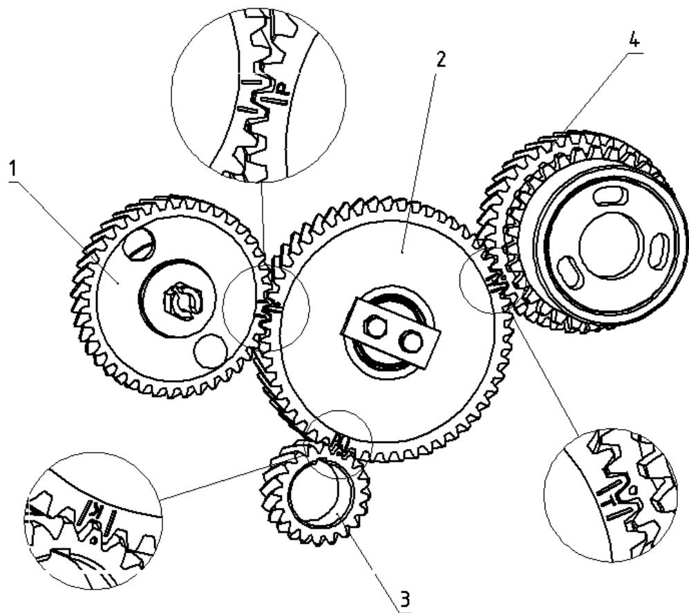
1 - шестерня распределительного вала; 2 - промежуточная шестерня; 3 - шестерня коленчатого вала; 4 – шестерня привода топливного насоса.
