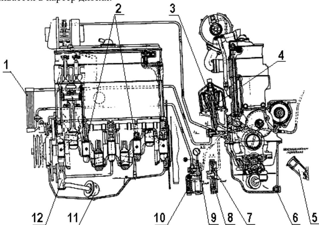
1 - масляный радиатор; 2 - форсунки охлаждения поршней; 3 - центробежный масляный фильтр; 4 - защитная фильтрующая сетка; 5 - маслозаливная горловина; 6 - пробка масляного картера; 7 - редукционный клапан; 8 - сливной клапан; 9 - манометр; 10 - предохранительный клапан; 11 - маслоприемник; 12 - масляный насос.
