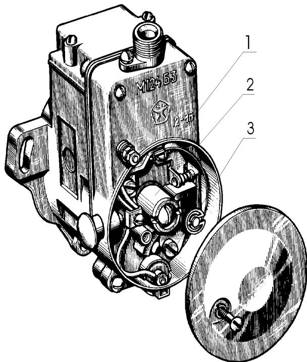
1 - винт; 2 - ось ротора; 3 - эксцентрик.
