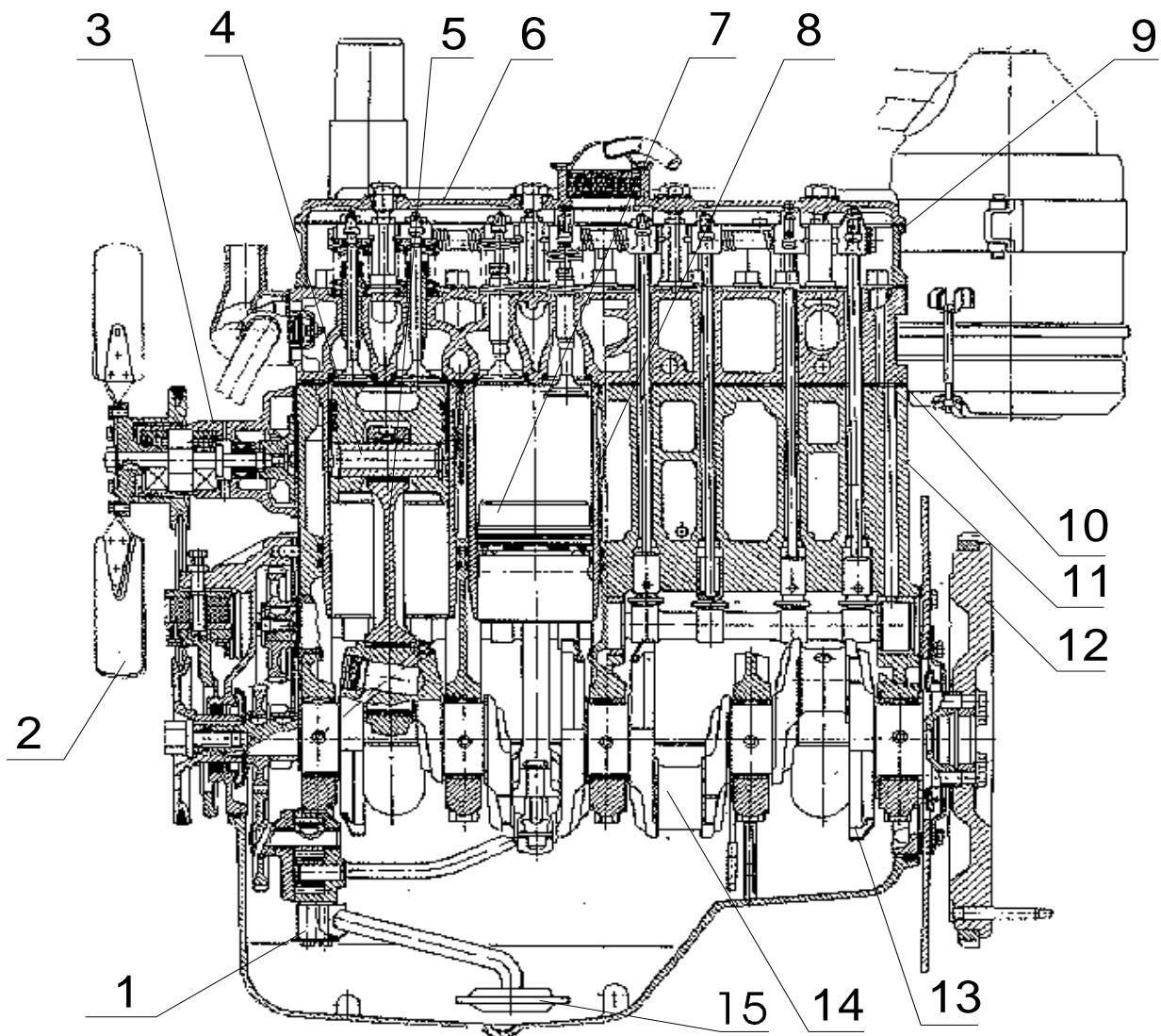
1 - насос масляный; 2 - вентилятор; 3 - водяной насос; 4 - палец поршневой; 5 - шатун; 6 - колпак; 7 - поршень; 8 - гильза цилиндров; 9 - крышка головки цилиндров; 10 - головка цилиндров; 11 - блок цилиндров; 12 - маховик; 13 - противовес; 14 - вал коленчатый; 15 - маслоприемник.
