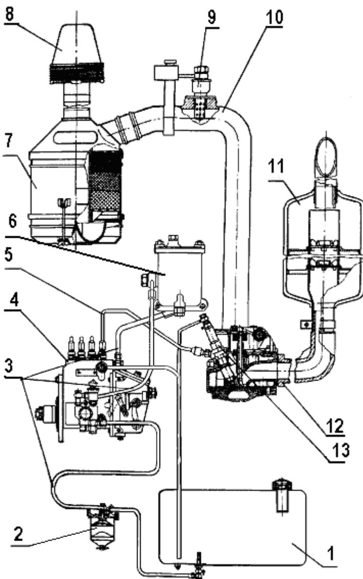
1 - топливный бак; 2 - фильтр грубой очистки топлива; 3 - трубки топливные; 4 - топливный насос; 5 - трубка топливная высокого давления; 6 - фильтр тонкой очистки топлива; 7 - воздухоочиститель; 8 - фильтр грубой очистки воздуха; 9 - электрофакельный подогреватель; 10 - впускной коллектор; 11 - глушитель; 12 - выпускной коллектор; 13 - форсунка.
