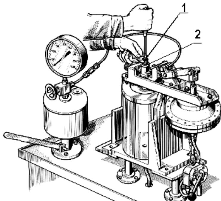
1 - винт регулировочный; 2 - контргайка.
