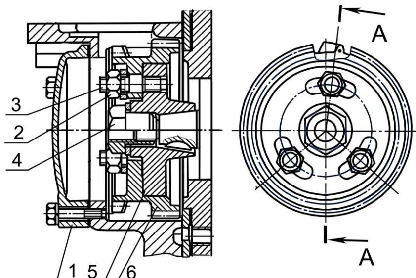
1 – крышка люка; 2 – гайка; 3 – шпилька; 4 – гайка специальная; 5 – фланец;
