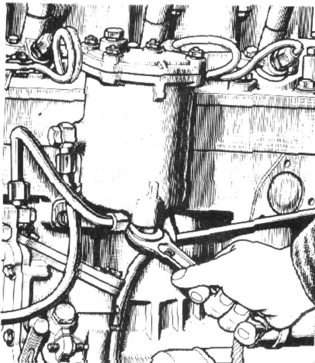
Рисунок 17 - Слив отстоя из фильтра тонкой очистки топлива
