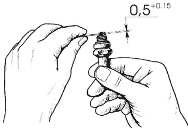
Рисунок 23 – Проверка зазора между электродами свечи
