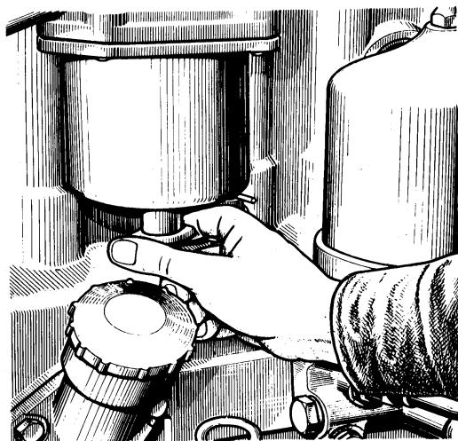
Слив отстоя производите через 125 часов работы дизеля.
