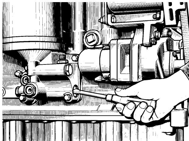
Рисунок 15 - Регулировка сливного клапана центробежного масляного фильтра
