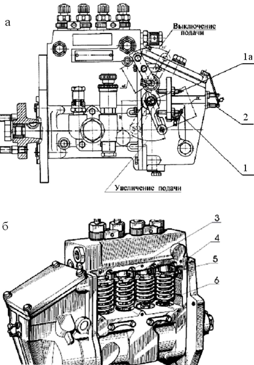
1 – винт регулировочный скоростного режима; 1а - винт регулировочный минимального холостого хода; 2 - болт номинала (упор); 3 - венец зубчатый; 4 - винт стяжной; 5 - втулка поворотная; 6 - регулировочный болт толкателя с контргайкой.
