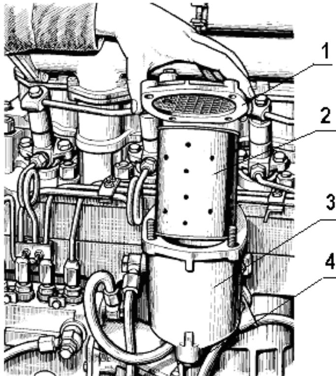
1 - крышка фильтра; 2 - элемент фильтрующий; 3 - корпус фильтра; 4 - пробка.
