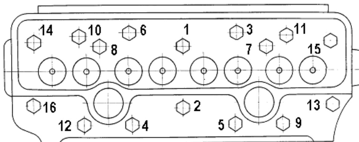
Рисунок 19 - Схема последовательности затяжки болтов крепления головки цилиндров
