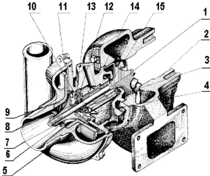
1 - колесо турбины с валом; 2 - корпус турбины; 3 - моновтулка; 4 - маслоотражатель; 5 - кольцо эксцентрическое; 6 - колесо компрессора; 7 - гайка специальная; 8, 15 – уплотнительные кольца; 9 - диффузор; 10 - крышка; 11 - корпус компрессора; 12 –упорный подшипник; 13 – втулка распорная; 14 - корпус средний (корпус подшипников).
