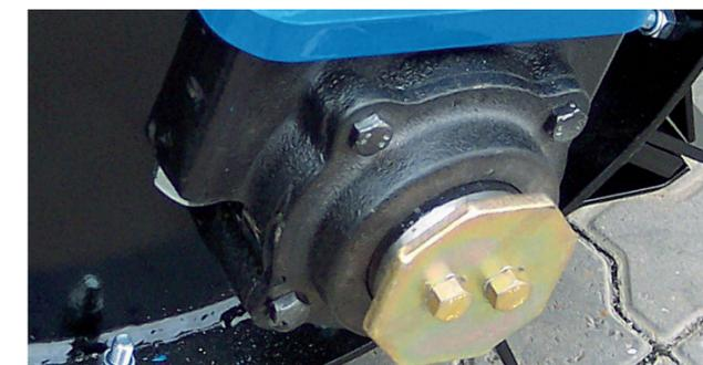
Роллер представляет собой стальной барабан 610x7мм, который необходимо заполнить водой, чтобы придать дополнительный вес. На роллер установлены ножи 100мм, т.е. общий диаметр составляет 810мм. MaxiCut может работать при скорости 18-25 км/ч и площадь в 10 гектар может быть обработана за один час. Из-за высокой рабочей скорости и потребляемой мощности барабан должен быть оснащен стальными осями 70мм и большими коническими роликовыми подшипниками со двоянными манжетными уплотнениями.
