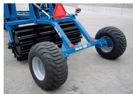
MaxiCut 600 оснащен стандартными колесами размером 400/60x15,5.
