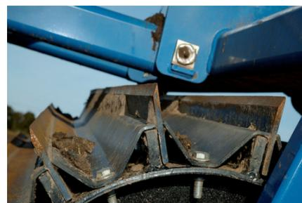
MaxiCut оснащен специальными закаленными ножами, которые во время работы с рабочей скоростью 18-25 км/ч гарантируют необходимый результат (и измельчение пожнивных остатков). Измельчение осуществляется за счет 15 наборов ножей, которые расположены по всей поверхности барабана. Барабан имеет нагрузку приблизительно 1000кг веса на метр по всей рабочей ширине. Корни пожнивных остатков остаются в земле минимизируя выход азота.
