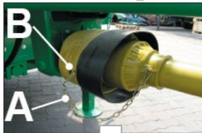
Рисунок 5.3 Фиксация защитного кожуха карданной передачи кормораздатчика
