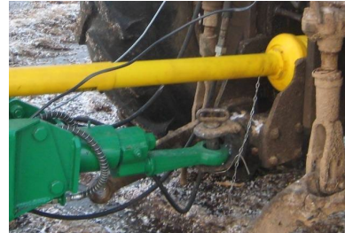
Рисунок 5.3 Фиксация защитного кожуха карданной передачи кормораздатчика
