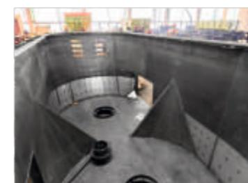
**Кольцо в верхней части бункера с увеличенным вылетом** предотвращает высapsulation корма при перемешивании.
