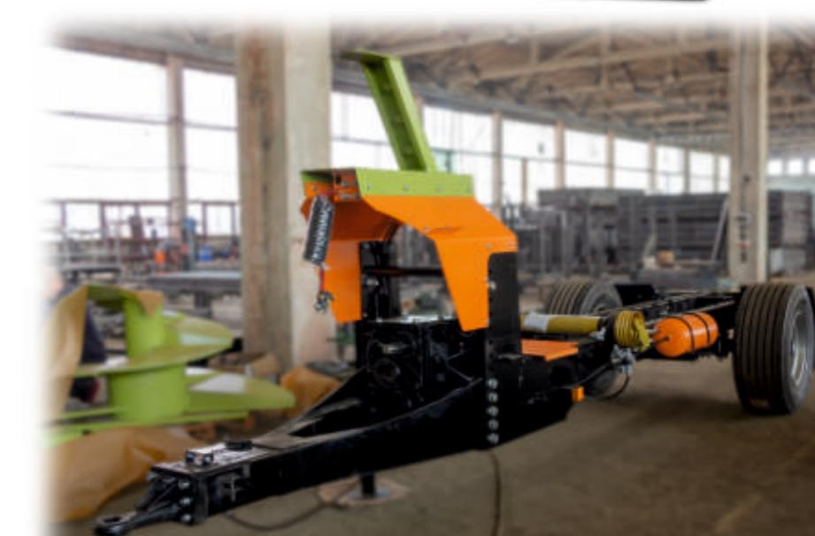
**Дышло зауженное в передней части** – позволяет обеспечивать повороты трактора без касания его задними колесами.
