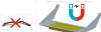
**Каждое выгрузное окно** оборудовано съемным выгрузным лотком, на который можно (под заказ) установить дополнительный лоток регулируемый по углу наклона или **лоток с мощным магнитом** (для извлечения из кормосмеси возможных металлических включений).
