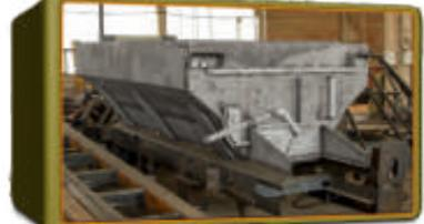
**Бункер и детали транспортера** (ролики, метизы, и т. д.), **металлоконструкция узла внесения** (распределения) выполнены из нержавеющей стали - продлевает срок службы МВМУ при работе с самыми агрессивными видами удобрений.
