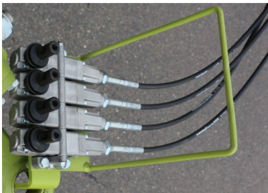
Рисунок 6. Пульт дистанционного управления золотниками гидрораспределителя (тросовый).
