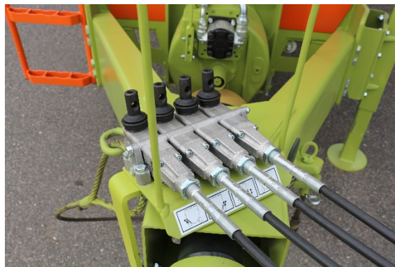
Рисунок 6. Пульт дистанционного управления золотниками гидрораспределителя (тросовый).
