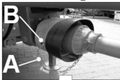
Рисунок 5.2 Фиксация защитного кожуха карданной передачи кормораздатчика
