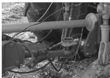
Рисунок 5.2 Фиксация защитного кожуха карданной передачи кормораздатчика
